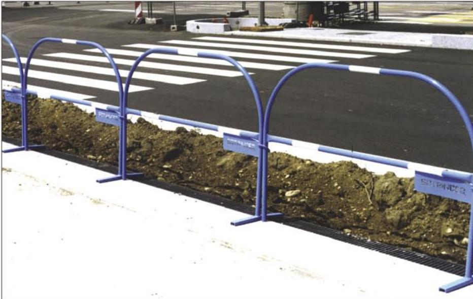
Acier, tube  $\varnothing 30 \times 1,5$  mm. Pied cambré en U permettant le passage rapproché des roues d'engin. Finition plastifiée selon nuancier RAL, avec adhésifs. Logo personnalisé et adhésifs réfléchissants en option.
